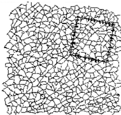
Рисунок С.1 — Поиск зоны разрушения с самыми крупными осколками
